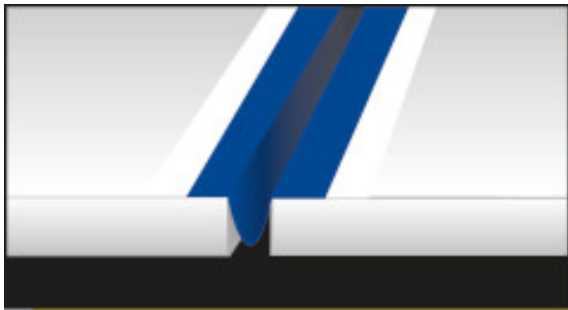
Schlaufenförmiges Einarbeiten von Mapeband im Dehnfugenbereich
