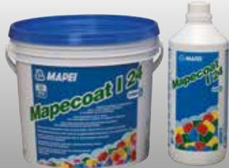
Nach Bedarf kann **Mapecoat I 24** neutral während des Anmischvorganges mit **Mapecolor Paste** eingefärbt werden. Dabei wird je 5 kg-Einheit **Mapecoat I 24** jeweils 0,7 kg **Mapecolor Paste** (pastöses Farbpigment) zugegeben.
